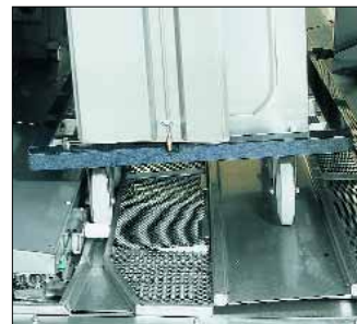
Die Schrägstellung vermeidet die Verschleppung von Wasser und beschleunigt die Trocknung.
