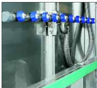
Hygienesicherheit durch energiesparende thermochemische Desinfektion oder Thermodesinfektion durch 85° C heißer Nachspülung.
